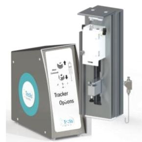
L'option ÉCHANGE DE PHASE DANS LA GOUTTE mesure la tension superficielle d'une bulle dont le gaz est échangé ou la tension interfaciale d'une goutte dont le liquide est échangé grâce à double capillaire coaxial, tout en maintenant son volume constant. Le débit d'échange peut être réglé et le logiciel contrôle les cycles d'injection.
