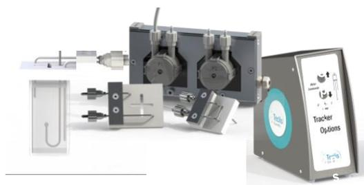
L'option ÉCHANGE DE PHASE DANS LA CUVETTE mesure la tension superficielle d'une bulle ou la tension interfaciale d'une goutte formée dans la cuvette dont le liquide est échangé. Les conditions idéales de mélange sont établies par agitation et en maintenant un débit constant à l'intérieur de la cuvette.
